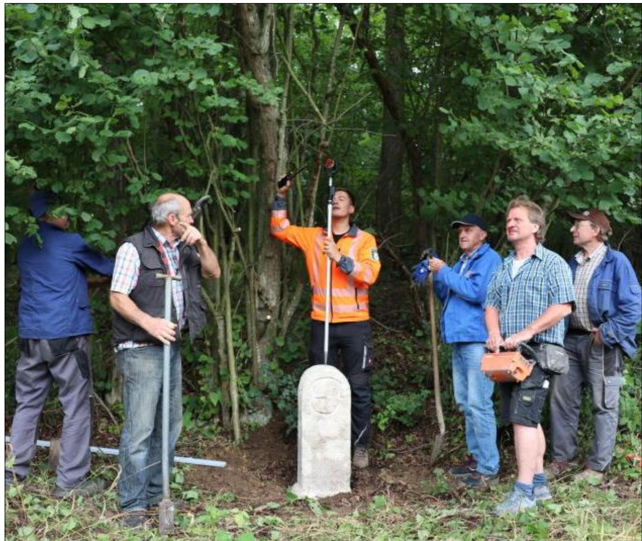
Vermessungsfachleute sorgten dafür, dass der 400 Jahre alte renovierte Stein exakt in der richtigen Position gesetzt wurde. Foto: Thomas Schaller
